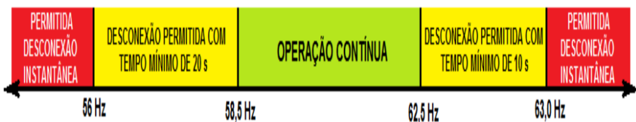
Figura 1 - Faixas de operação da central geradora em regime de frequência não nominal [15].
