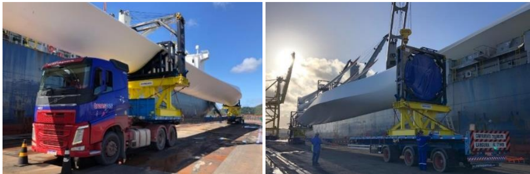
Figura 19 – Posicionamento da pá eólica nos dispositivos
