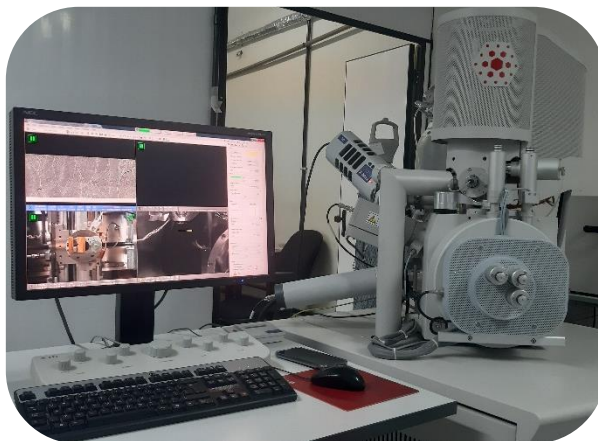
Figura 02 - Microscópio Eletrônico de Varredura Quanta 450-FEG
